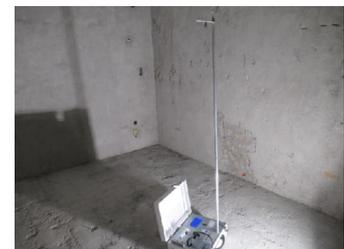
VDI-Luftmessung nach Sanierung
